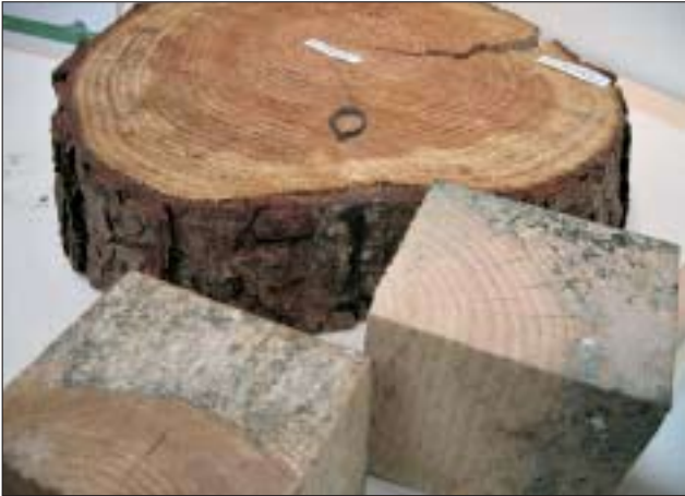
Durch eine feucht-warme Lagerung lässt sich die keimtötende Wirkung der Kiefernkerneholz enthaltenen Holzinhaltsstoffe eindrucksvoll demonstrieren.
