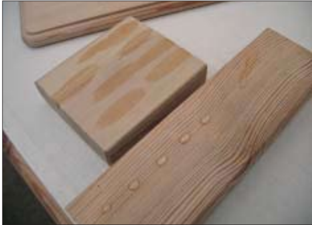
Das „Hygieneholz“-Prinzip: ein Waschprozess löst das Harz heraus, sodass Keime schneller in das Holz transportiert und von den Holzinhaltsstoffen abgetötet werden können.
